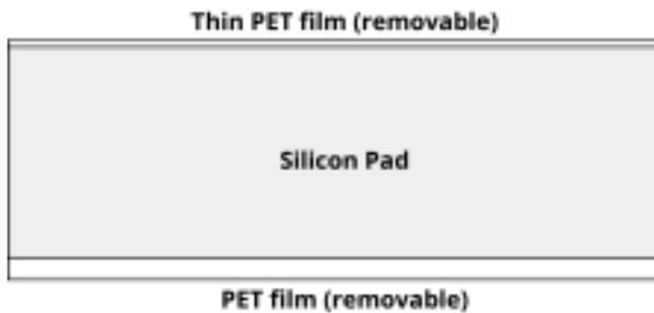
Un tampon entièrement en silicone recouvert d'un film PET sur les deux surfaces de contact pour une stabilité accrue et une installation facile. Les deux doivent être retirés pour l'installation.
